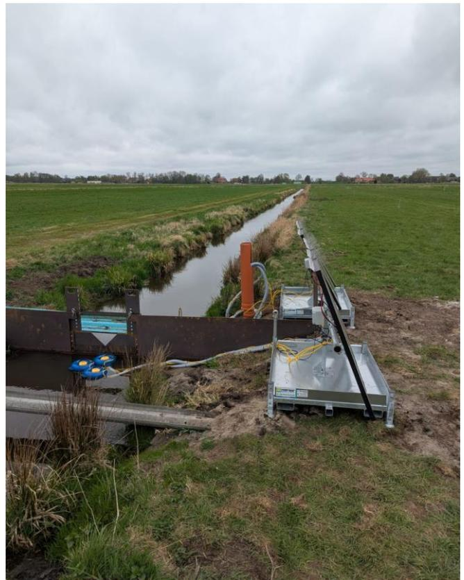
ABBILDUNG 1 LINKS: MOBILE MESSHAUBE, DIE ZUR TREIBHAUSGASMESSUNG EINGESETZT WIRD. IM HINTERGRUND IST EIN BODENFEUCHTESENSOR ZU ERKENNEN. RECHTS: DURCH SOLARBETRIEBENE PUMPEN WIRD MIT HILFE EINES SCHWIMMERS DER WASSERSTAND GEHALTEN.
